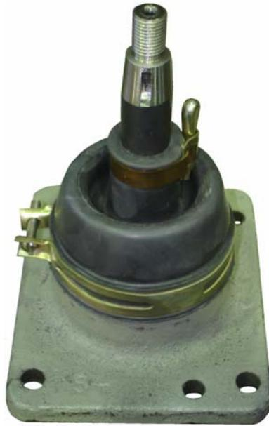
**Рисунок 16 – Внешний вид рычага переключения передач с опорой в сборе КП типа ЯМЗ-239-03**
