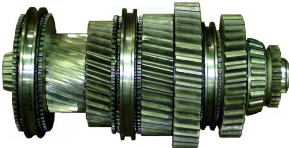
**Рисунок 8 – Внешний вид вала вторичного в сборе дет. 239.1701100 КП ЯМЗ-239**
