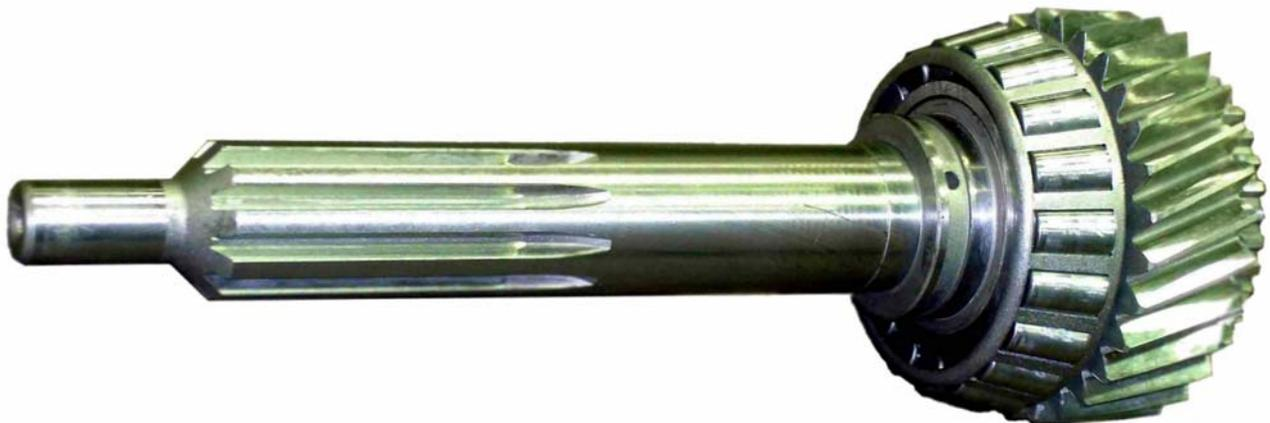
**Рисунок 3 – Внешний вид вала первичного в сборе, дет. 239-1701025-10, без наружного кольца подшипника**
