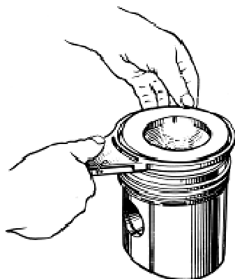
Рис. 79. Щипцы для снятия и надевания поршневых колец: 1 – поршневое кольцо; 2 – губки щипцов; 3 – рукоятка
