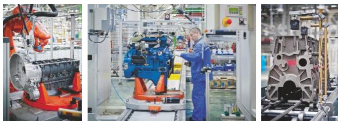
Производство средних рядных двигателей ЯМЗ-530
